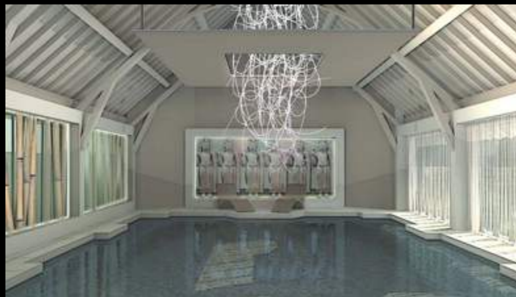
Fibres optiques diffusantes de 2mm tendues à l'aide de ressorts. Présentoir Estée Lauder
